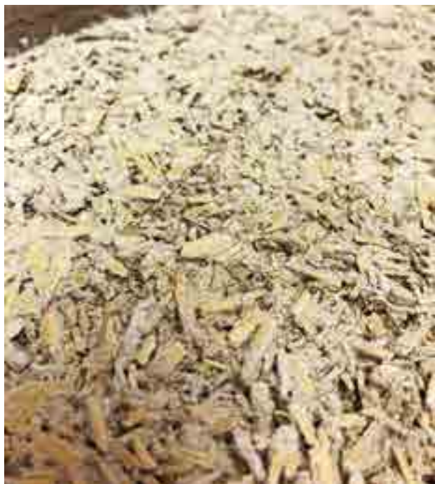
Gros plan de l'enduit chaux chanvre couleur naturelle.
