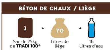
Dans la bétonnière, introduire le liège et 14 litres d'eau, Malaxer environ 3 minutes pour humidifier le liège puis ajouter un sac de chaux Pure Tradi 100® NHL 5 ; Ajuster si nécessaire le dosage en eau afin d'obtenir un mélange homogène.
